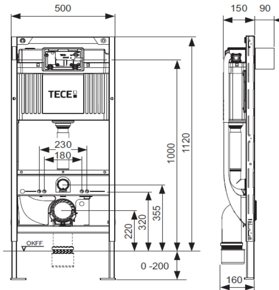
Les dimensions en millimètres s'entendent sous réserve des tolérances d'usine, d'éventuelles modifications ultérieures, de même que de nouvelles possibilités de montage. La responsabilité ne peut être engagée en cas de cotes manquantes ou erronées (CO art. 100)
