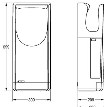
Sèche-mains grande vitesse « hands-in » hygiénique grâce à un actionnement à commande opto-électronique et filtre HEPA intégré, pour montage mural, en plastique ABS antibactérien, couleur argent, temps de séchage de 7 à 10 secondes, vitesse de l'air réglable, air chaud ou froid en option, arrêt automatique après 25 secondes, réservoir d'eau et écoulement pouvant être nettoyés séparément, type de protection IPX4. Câble et prise non fournis.
