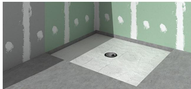
2. Connectez la bonde au vidage; réalisez une base en mortier et collez avec un adhésif d'au moins de classe C2, appliqué avec un peigne crantée. Ne pas coller le receveur de douche avec points ou plots de colle.
